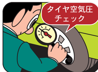
タイヤのエアバルブ（空気入れ）のキャップを外し、そこにタイヤゲージの口金を入れて測定します。
